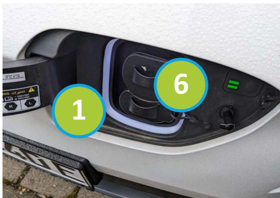
Entfernen Sie an der fahrzeugseitigen Ladebuchse die Abdeckkappen (6). Dann das Ladekabel am Fahrzeug sowie an der Ladestation einstecken.
